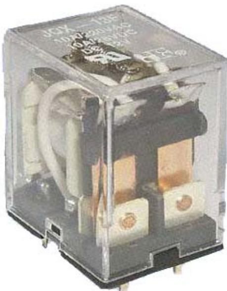
Slika 1.2 Fotografija elektromehaničkog releja.
