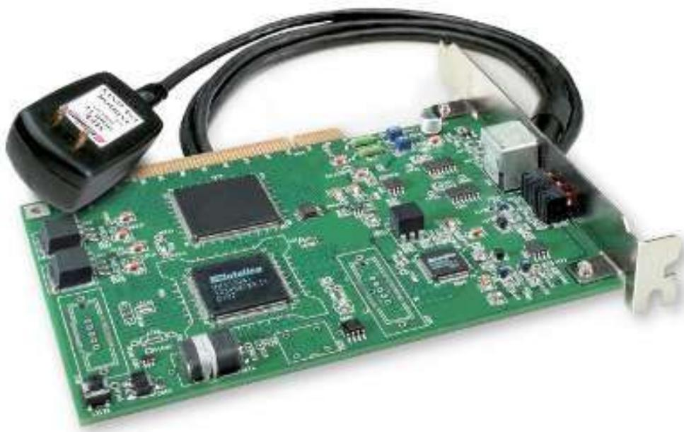
Slika 4.5. PCI računalna kartica s priključkom na PLC
