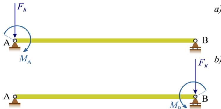
Slika 3.17. *Primjer 3.3.: a) redukcija zadanog sustava na točku A, b) redukcija zadanog sustava na točku B.*
