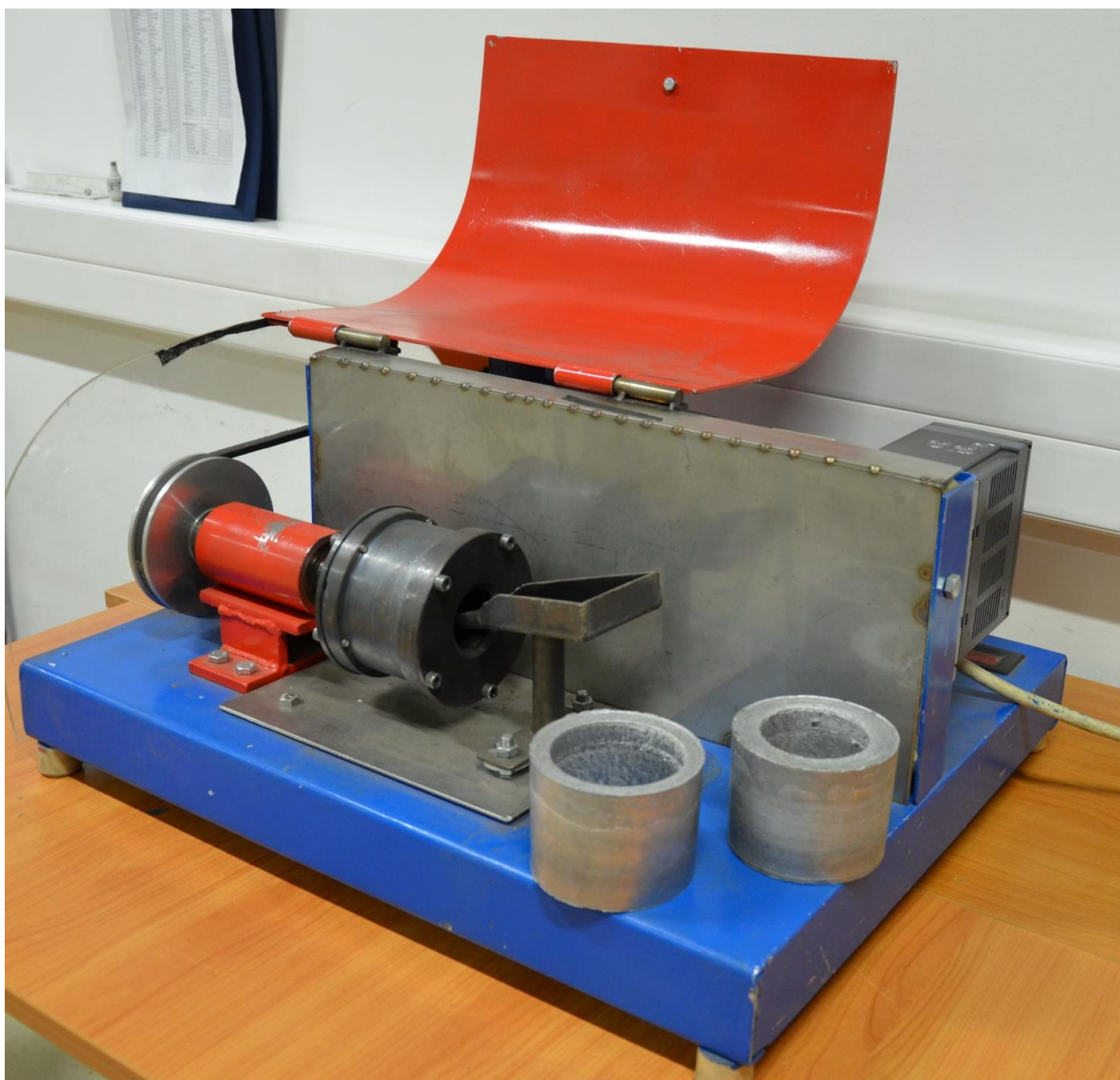
Slika 4. Uređaj za izradu horizontalnog centrifugalnog lijeva s odljevcima različite debljine stijenke
