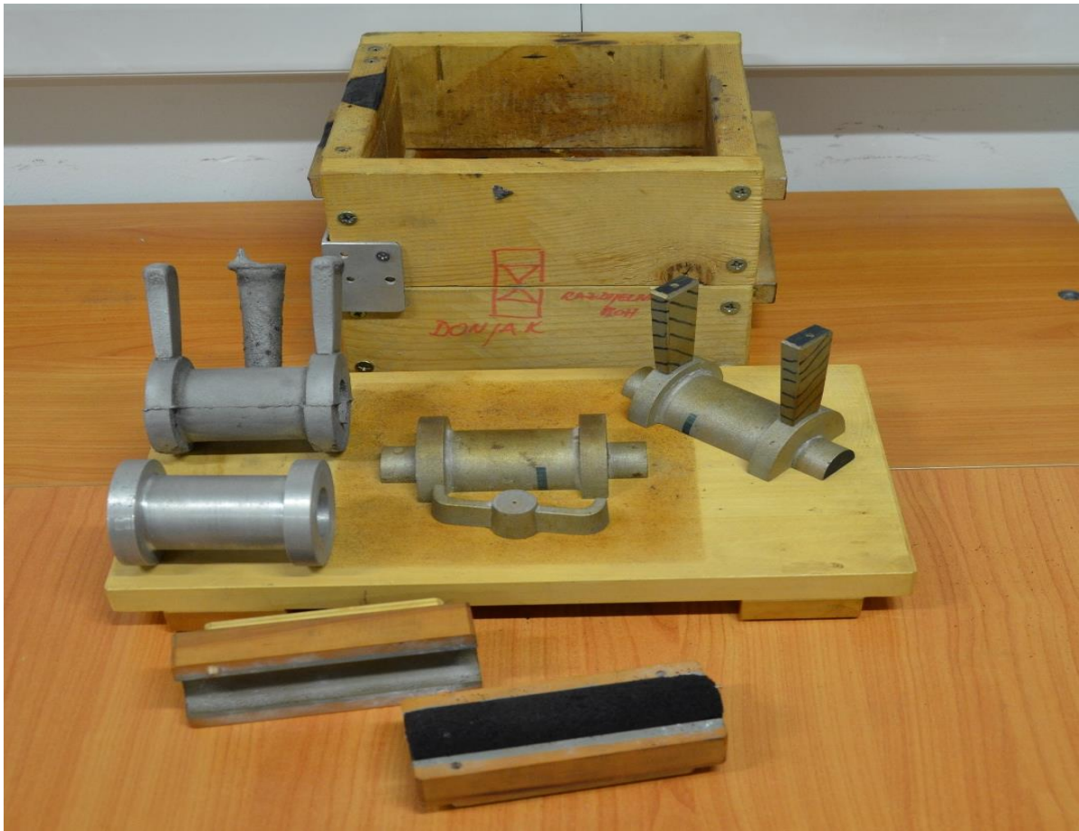
Slika 2. Na slici je prikazan višedijelni model s modelnom pločom, kalupnicma (donjak i gornjak), jezgrenici s izrađenom jezgrom te gotovi i obrađenim odljevak
