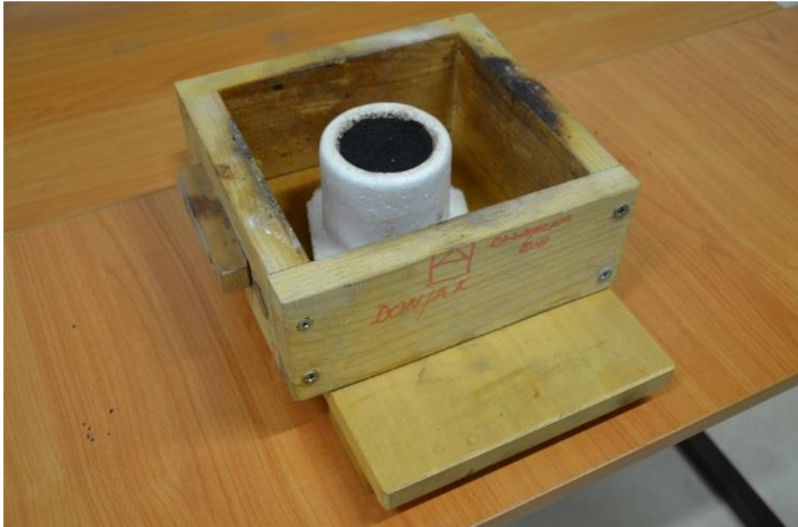
Slika 5. Na slici je prikazan donjak i jednokratni lako isparivi model s zapunjenom jezgrenom šupljinom
