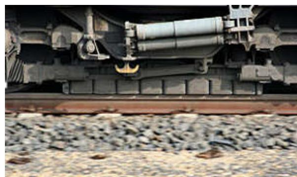
Kočnica temeljena na vrtložnim strujama na visokobrzinskom njemačkom ICE3 vlaku
