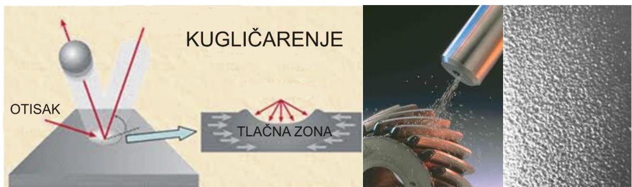
*Slika 2.46. Obrada površine kugličarenjem [13]*
