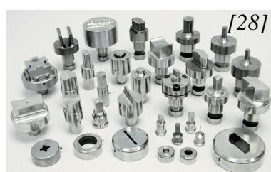
Svojstva prevlake: velika površinska tvrdoća ( $\approx 2000$  HV), dobro prianjanje na osnovni metal, dobra kemijska postojanost, nizak koeficijent trenja, velika temperaturna postojanost, mala naprezanja u strukturi, moguće veće debljine prevlake. Srebrno sive je boje. Maksimalna radna temperatura iznosi  $600^\circ\text{C}$ .
