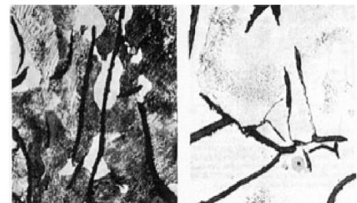
*Slika 5.3. Struktura nelegiranog sivog lijeva u lijevanom stanju (lijevo, 180 HB) i stanju nakon feritacijskog žarenja 1 sat na 760°C (desno, 120 HB) [14]*
