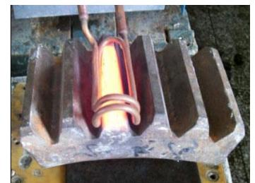
*Slika 1.64. Samokaljenje površine zuba zupčanika*
