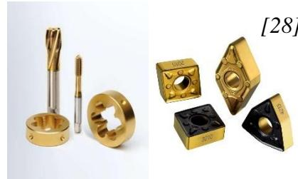
Svojstva prevlake: velika površinska tvrdoća ( $\approx 2300$  HV), dobro prianjanje na osnovni metal, nizak koeficijent trenja, dobra kemijska postojanost, povećana žilavost, ekološki prihvatljive, niska toplinska vodljivost. Debljina prevlake iznosi  $2\div4$   $\mu\text{m}$ . Maksimalna radna temperatura iznosi  $500^\circ\text{C}$ .
