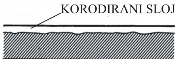
*Slika 4.12. Jednolična korozija homogenog metala*
