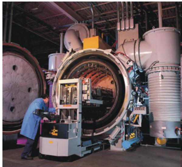
*Slika 1.61. Vakuum peć [13]*
