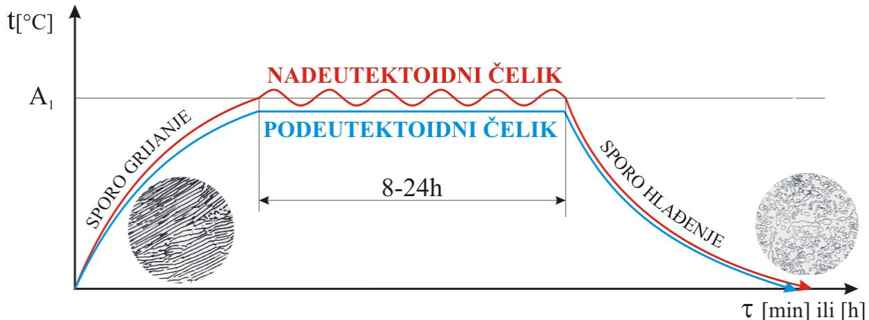
Slika 2.34. Omekšavajuće žarenje – dijagram toplinske obrade za podeutektoidni i nadeutektoidni čelik [1]
