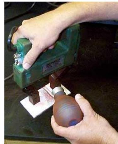
*Slika 3.11. Nanošenje feromagnetskih čestica suhom metodom [19]*
