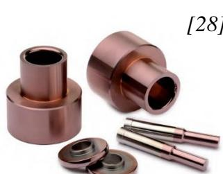
Svojstva prevlake: velika površinska tvrdoća ( $\approx 3500$  HV), dobro prianjanje na osnovni metal, nizak koeficijent trenja, povećana žilavost, visoka toplinska vodljivost, visoka otpornost na habanje na visokim temperaturama. Debljina prevlake iznosi  $2\div4$   $\mu\text{m}$ . Maksimalna radna temperatura iznosi  $400^\circ\text{C}$ . Svjetlo je sive boje.
