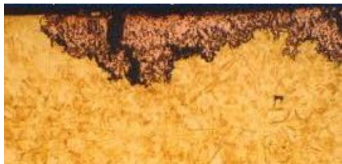
*Slika 4.17. Selektivna korozija (primjer korozije kod mjedi) [24]*
