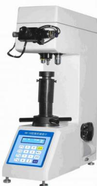
*Slika 14.21. Uređaj za ispitivanje tvrdoće po Vickers-u*
