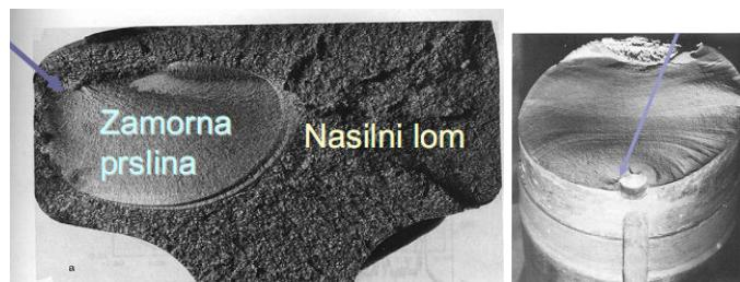
*Slika 3.14. Izgled površine prijeloma zbog dinamičkog opterećenja*
