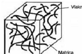
*Slika 9.2. Kompoziti s vlaknima*
