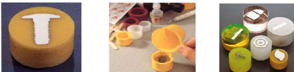
Slika 14.3. Umetanje uzorka u kalup sa polimernom masom
