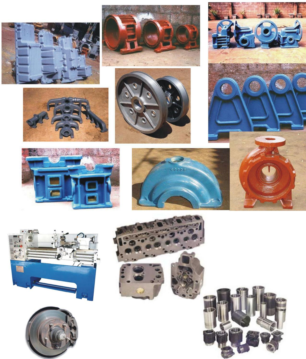
*Slika 6.29. Odljevci iz sivog lijeva*
