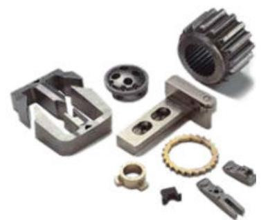
*Slika 7.3. Dijelovi dobiveni sraštanjem*
