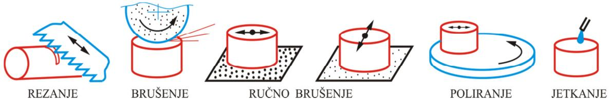
*Slika 14.5. Shematski prikaz postupka pripreme metalografskih uzoraka*
