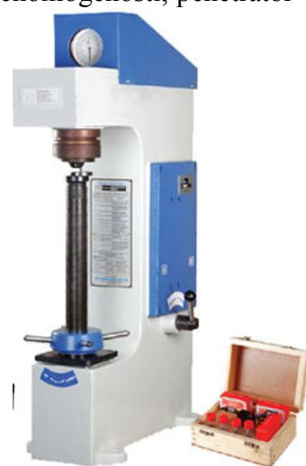
*Slika 14.24. Uredaj za ispitivanje tvrdoće prema Rockwellu*
