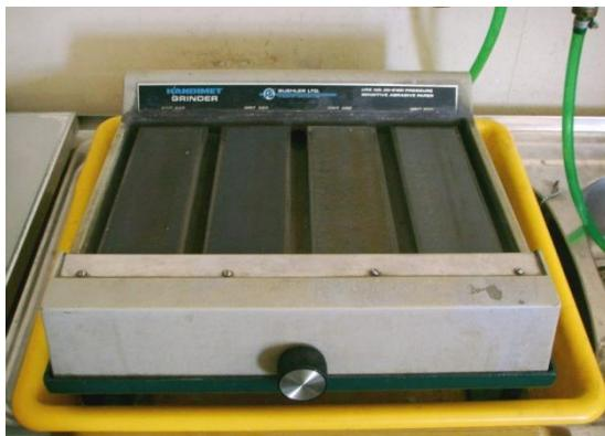
*Slika 4. Uređaj za ručnu pripremu uzoraka*
