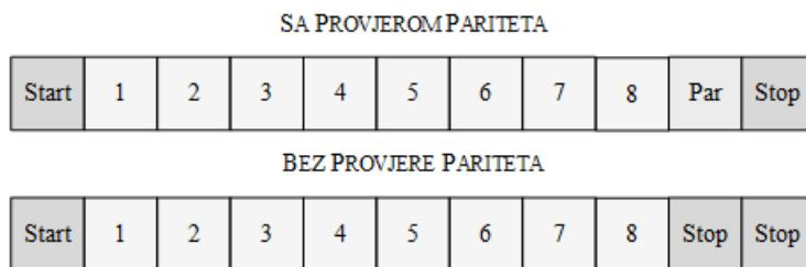
**Slika 13.9.** Struktura RTU okvira sa i bez pariteta
