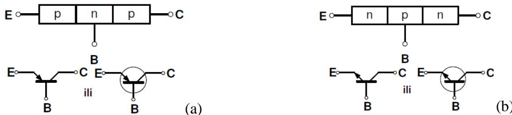
Slika 2.20. Shematski prikaz i simbol bipolarnog tranzistora: a) pnp tip, b) npn tip
