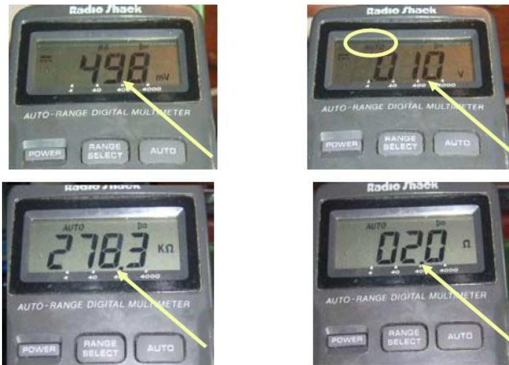
Slika 5.6. Razlučivost digitalnog instrumenta
