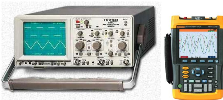
*Slika 6.1. Analogna i digitalna izvedba osciloskopa*
