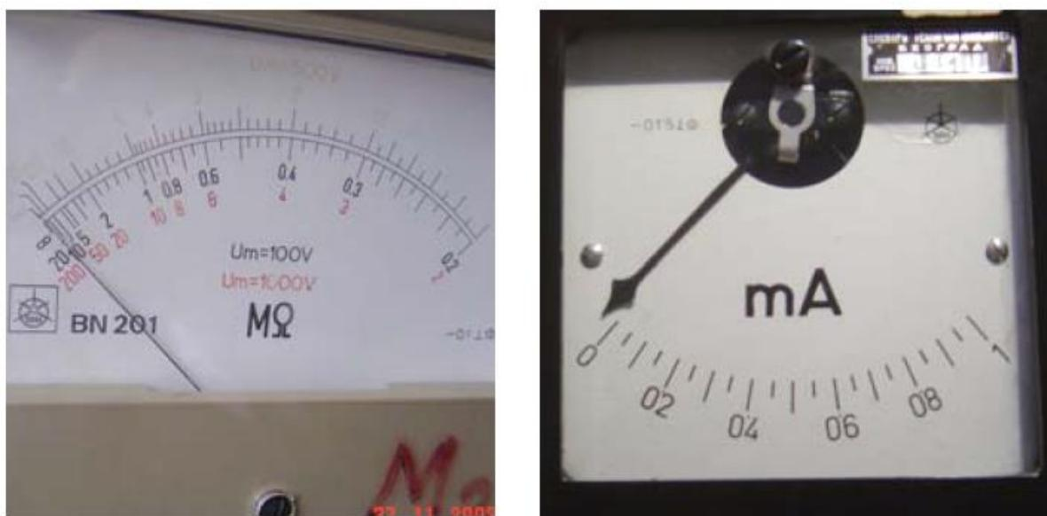
*Slika 5.5. Razlučivost analognog instrumenta*
