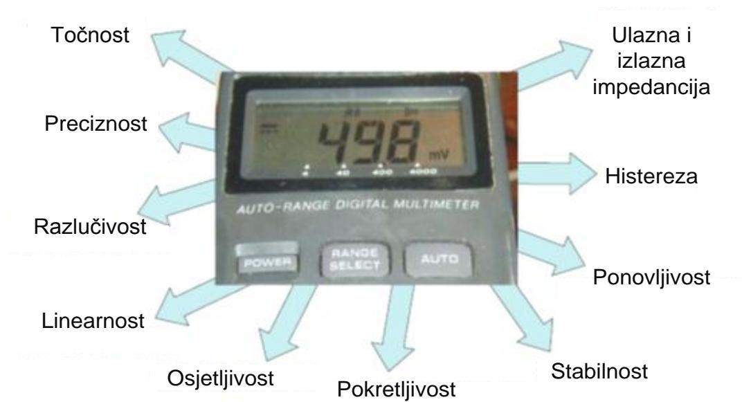
Slika 5.3. Karakteristike mjernog instrumenta
