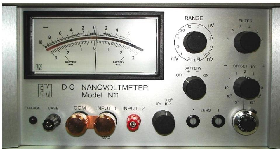
Slika 5.27. Vrhunski analogni vrlo točni nanovoltmetar
